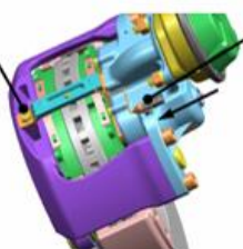
图 4-10: 绕线束、装螺栓 M10x20、制动块压板
